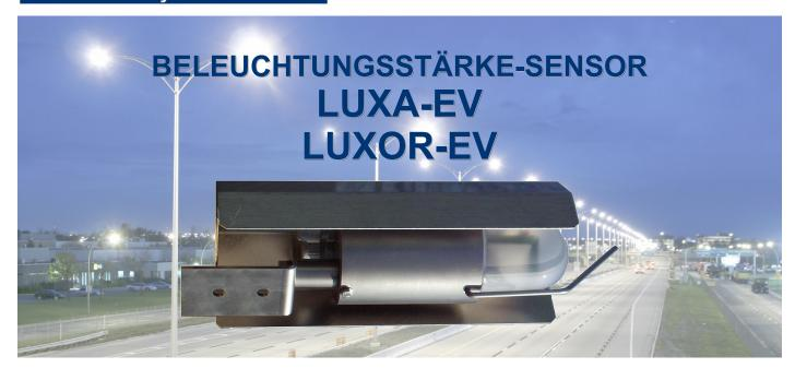
Der Beleuchtungsstärke-Sensor LUXA-EV / LUXOR-EV erfasst die vertikale Beleuchtungsstärke für die Steuerung von Beleuchtungsanlagen. Er ist nach Kundenanforderung für verschiedene Messbereiche zwischen 100 Lux und 150.000 Lux lieferbar.
